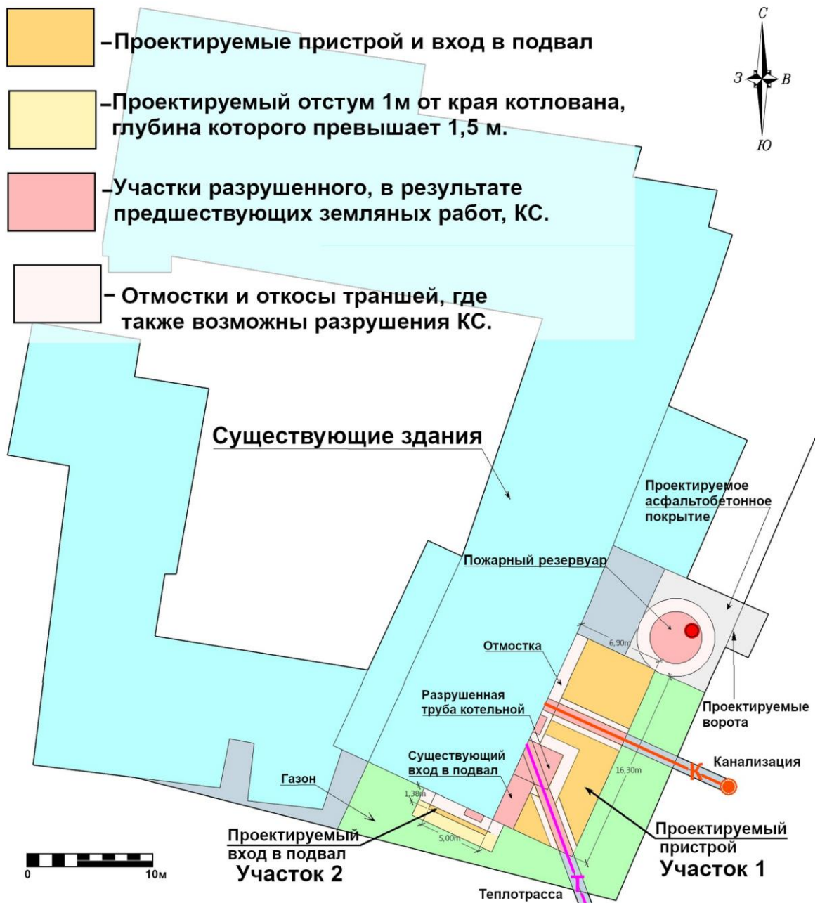
Ил. 30. План участка проектируемых работ с указанием разрушенных участков КС и проектируемых сооружений.
